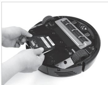
03. Retirer la batterie et la débrancher.
