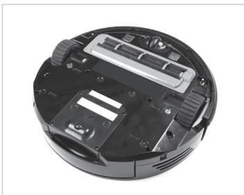
02. Retirer les quatre vis indiquées sur le schéma ci-dessous et ouvrir le couvercle.
