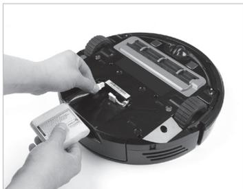
04. Rebrancher le clip de la batterie neuve puis insérez la batterie dans son compartiment.
