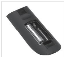
4. Tout en appuyant sur le bouton OK de la télécommande, réinsérer la pile manquante.
